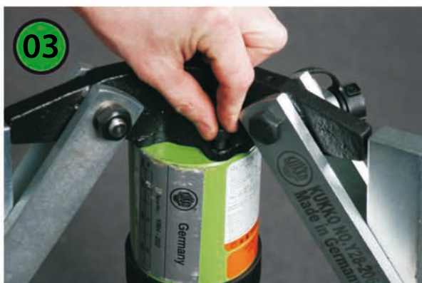
... und Zylinder an Traverse anschrauben
