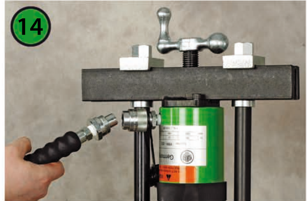
Schutzkappe an Zylinder entfernen und freies Ende des Pumpenschlauches mit Hydraulikzylinder verbinden
