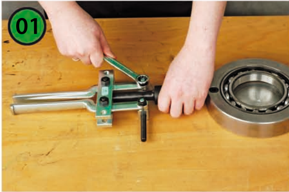
Spannweite passend zum Kugellager voreinstellen
