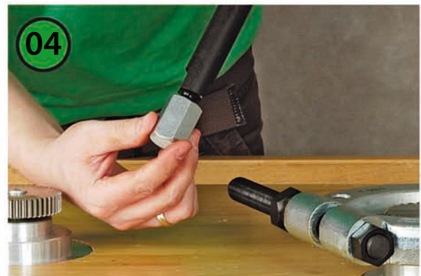
Abstützfüße, falls montiert, von den Zugbolzen abschrauben
