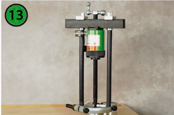
Mittelspindel mittels Handkurbel durchschrauben und vorspannen
