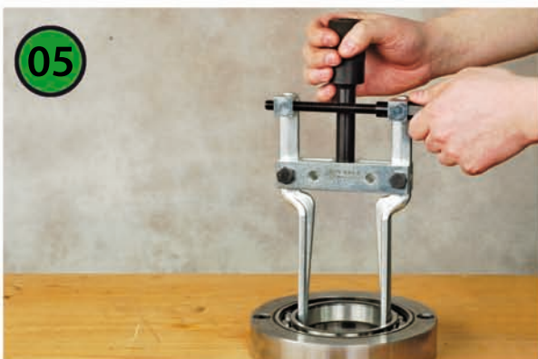
Haken ordnungsgemäß ausrichten und Vorspannung einstellen
