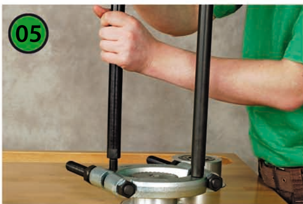
Zugbolzen in Trennmesser einschrauben
