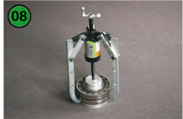
Haken ordnungsgemäß ausrichten und mit Handkurbel leichte Vorspannung einstellen. Zur ordnungsgemäßen Ausrichtung der Haken Hinweisblatt beachten!
