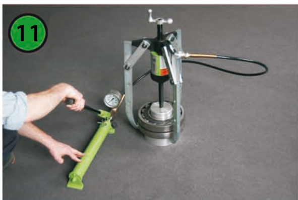
Durch Pumpen mit Abziehvorgang beginnen
