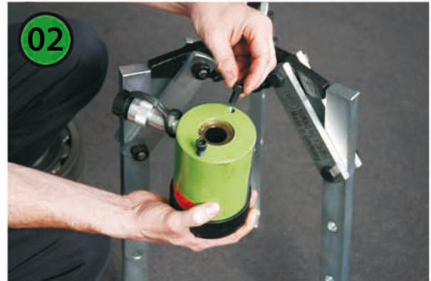
Schrauben aus Zylinderoberseite lösen ...
