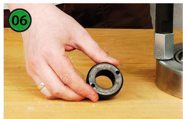
Zum Innenausziehen Druckstück mit glatter Bohrung am Zylinder verwenden!
