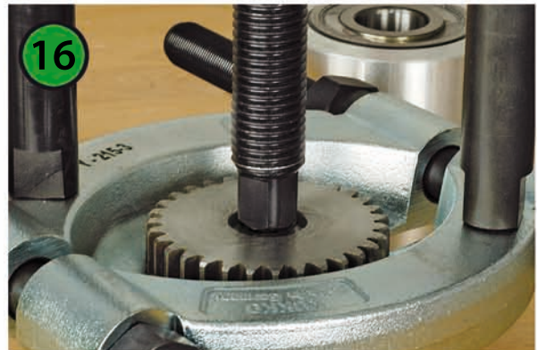
Relation zwischen Pumpendruck und Abziehkraft dem Aufkleber auf Zylinderseite entnehmen
