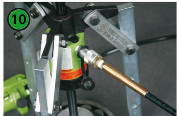
Freies Ende des Pumpenschlauches mit Hydraulikzylinder verbinden
