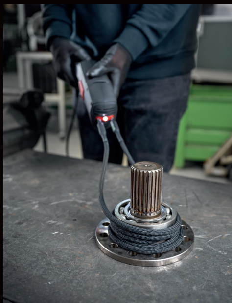
Oppvarming av et kulelager med en fleksibel varmespole
