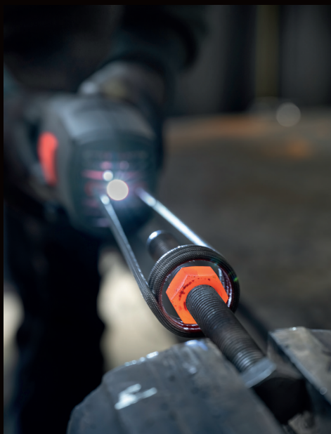
Hvis den interne temperaturen på enheten er for høy, avbrytes oppvarmingsprosessen automatisk.
