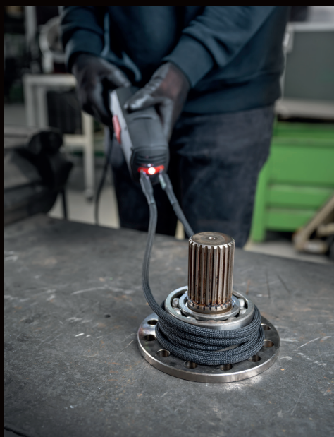
Golyóscsapágy felmelegítése rugalmas fűtőspirállal
