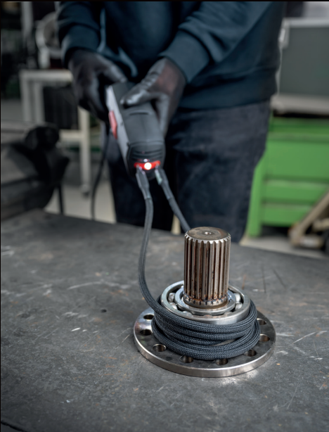
Bir rulmanı esnek ısıtma bobini ile ısıtma
