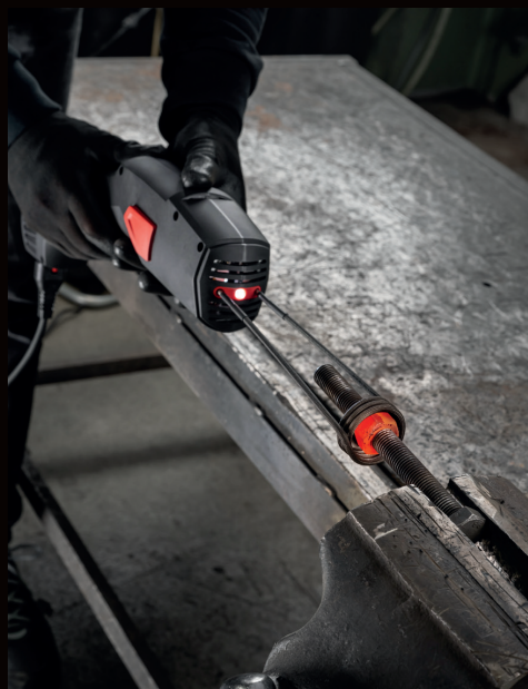
使用加热线圈加热螺母
