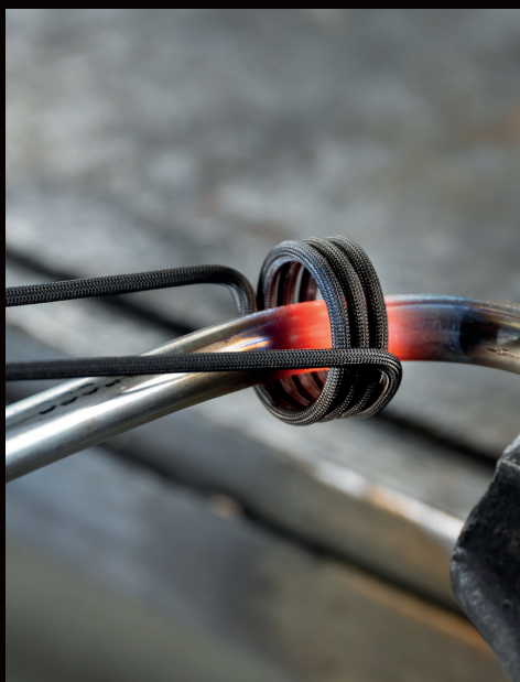
Нагрев трубы с помощью нагревательной спирали для последующего сгибания.
