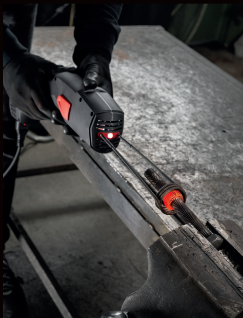
Erhitzen einer Mutter mit einer Heizspule
