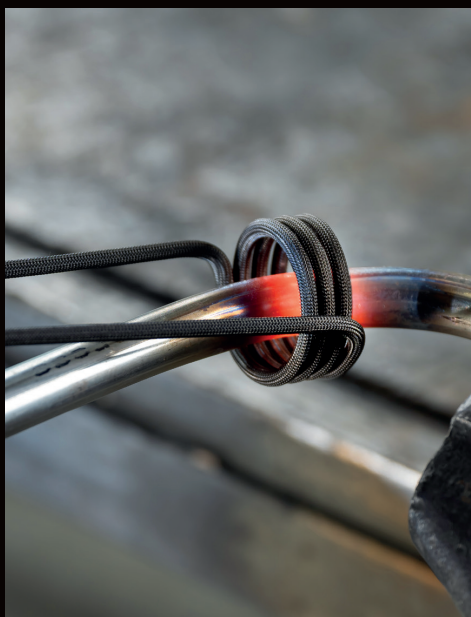
Oppvarming av et rør med en varmespole for å kunne bøye det etterpå.
