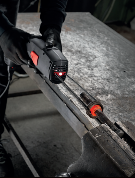
Bir somunu ısıtma bobini ile ısıtma
