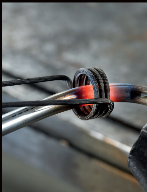
Chauffer un tuyau avec une bobine chauffante pour pouvoir ensuite le plier
