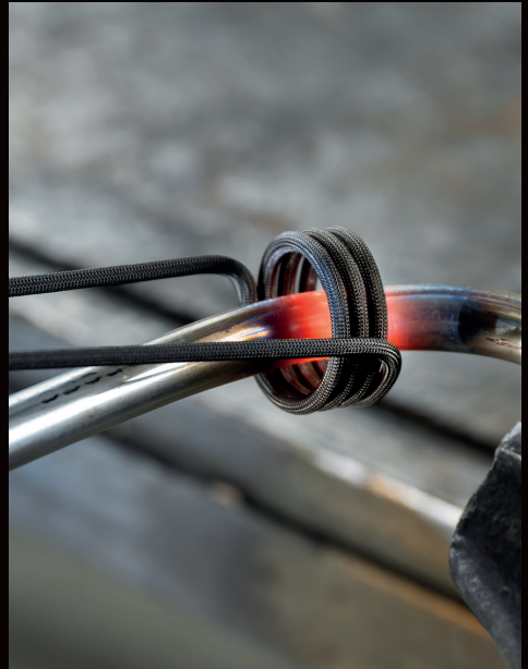
Bir boruyu bükkebilmek için ısıtma bobini ile ısıtma
