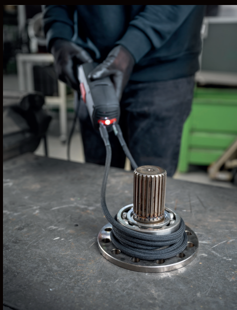
Încălzirea unui rulment cu o bobină flexibilă de încălzire
