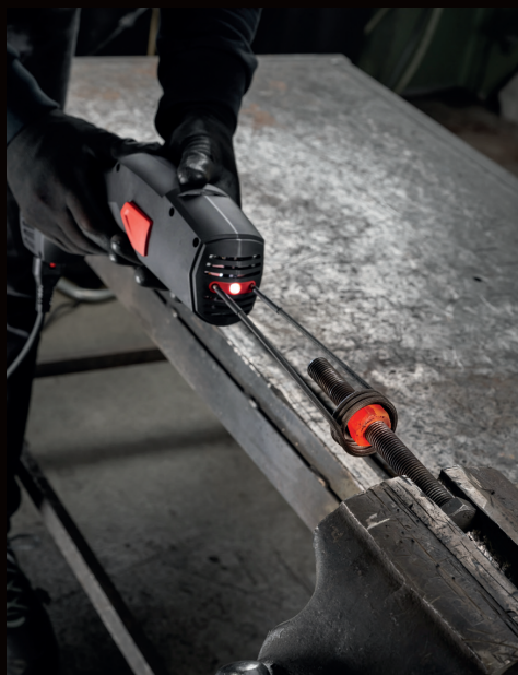
Нагрев гайки с помощью нагревательной спирали
