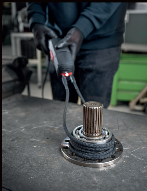
使用柔性加热线圈加热轴承
