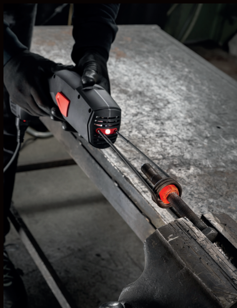
ナットを加熱コイルで加熱する
