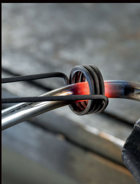
Încălzirea unei țevi cu o bobină de încălzire pentru a putea îndoi ulterior
