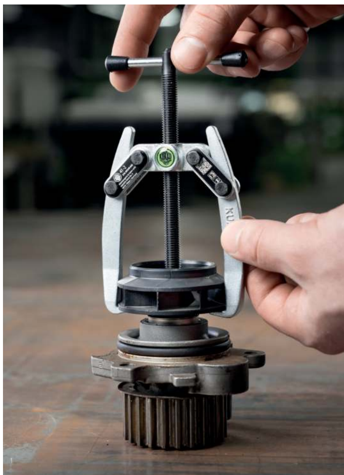
Abziehen eines Pumprads von einer Wasserpumpe am Auto mit dem 41-2
