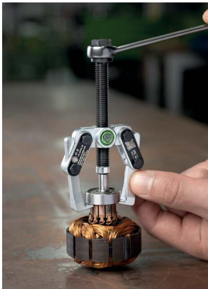
Abziehen eines kleinen Kugellagers von einer E-Motor-Welle mit dem 41-0
