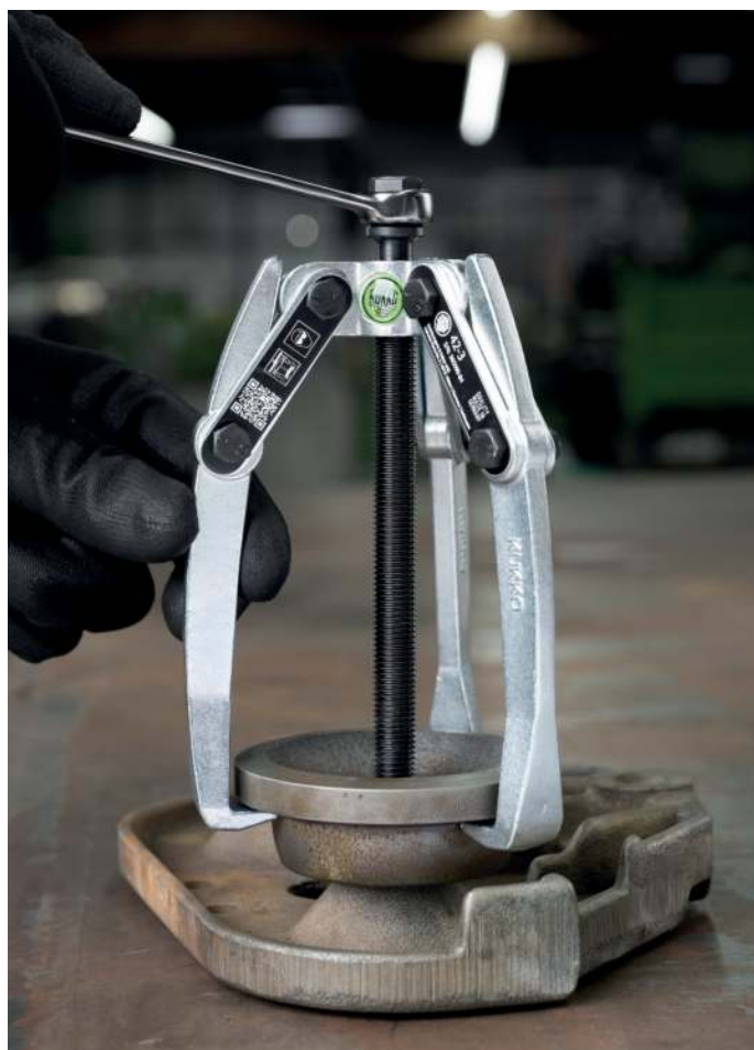
Demontage einer Umlenkrolle von einem Maschinenbauteil mit dem 42-3
